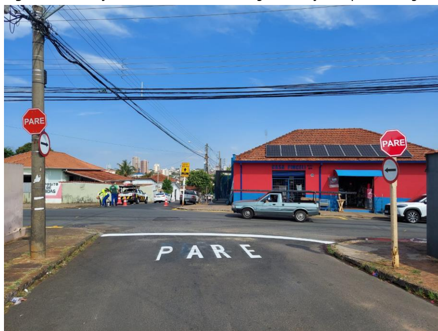
Figura 2. Sinalização vertical e horizontal de regulamentação de parada obrigatória.
